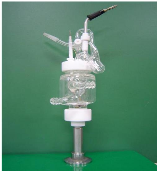
**FIGURA 6** – Célula eletroquímica utilizada no equipamento DEMS
