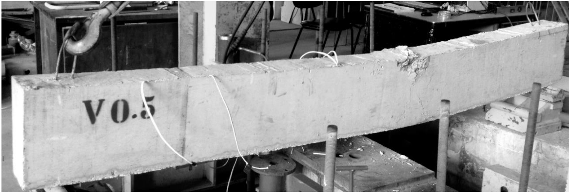
e) Viga após o ensaio ( V_u=178,0 kN)
