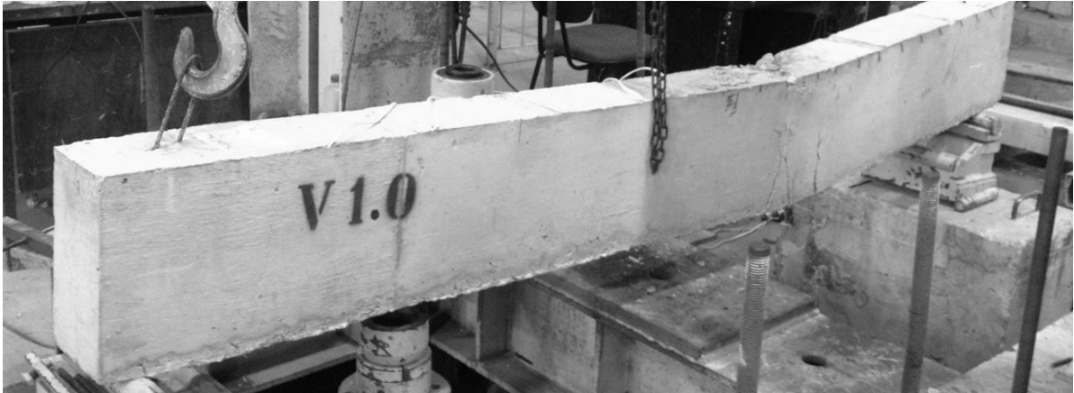
e) Viga após o ensaio ( V_u=176,5 kN) Figura 5.8 - Mapeamento das fissuras da viga V_{1,0} . Cont.
