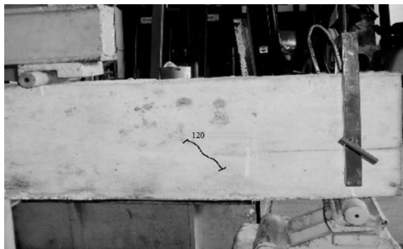
a) Carga: 0,67 \cdot V_u \approx 120,0 kN
