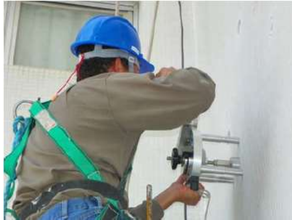
Figura 2.10 – Ensaio de arrancamento (Galletto e Andrello, 2013).
