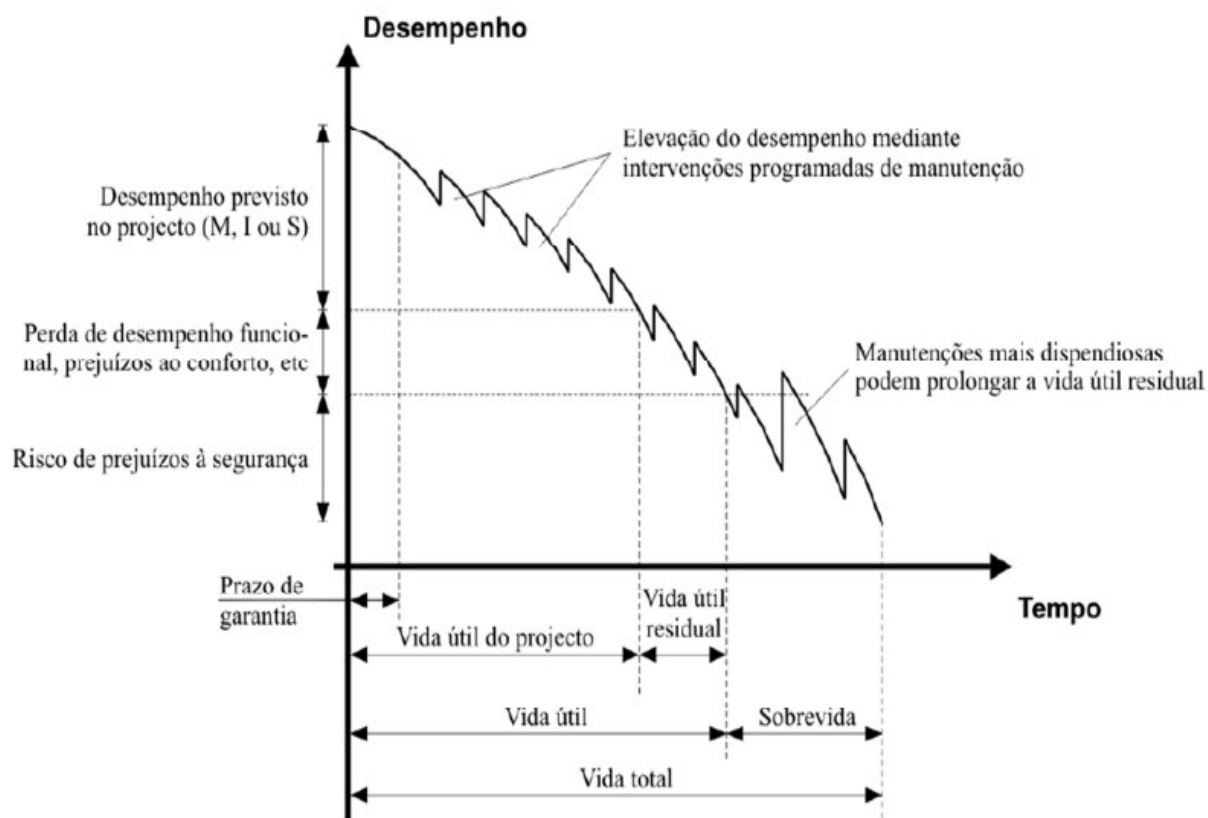
Figura 2.2 – Desempenho ao longo do tempo de um elemento ou sistema (NBR 15575-4, ABNT 2013).
