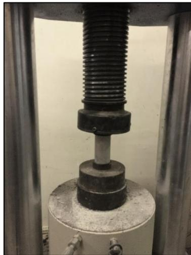
Figura 3.6 – Ensaio de compressão em argamassa
