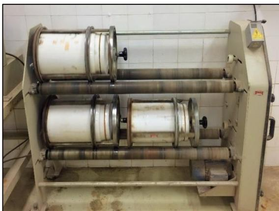
Figura 3.4 – Processo de moagem das cinzas do colmo do bambu
