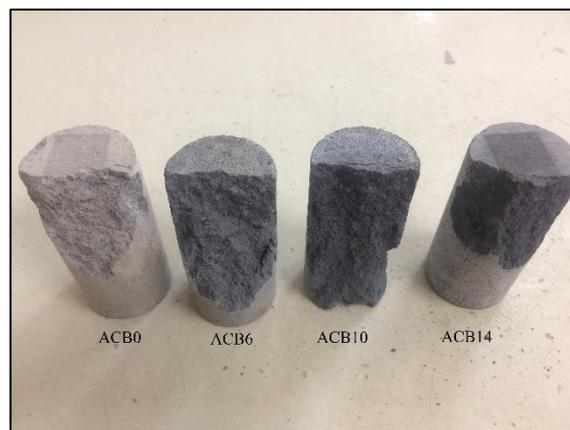
Figura 4.20 – Aparência das argamassas após ensaio de resistência à compressão (28 dias)
