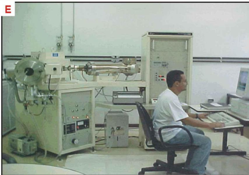
Figura 7.2- Equipamentos usados para análise geocronológica de zircão: A) Elutriador para separação de minerais “leves e pesados”; B) Separador magnético FRANZ; C) Tambor onde são colocados os filamentos com zircão; D) detalhe do tambor com os filamentos de evaporação e ionização; E) Espectrômetro de Massa FINNIGAN modelo MAT 262..
