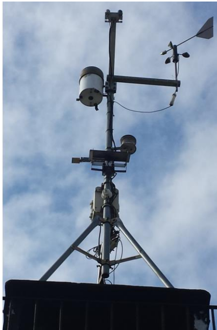
Figura 3.1. Estação Meteorológica próxima à edificação.
