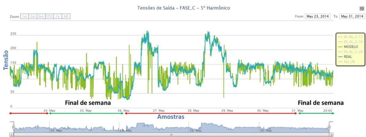
Figura 5-40 – Tensão real de saída e o modelo estimado da RNA de 5º harmônico para a fase C no barramento de 13,8 kV. Fonte: Elaborado pelo autor.
