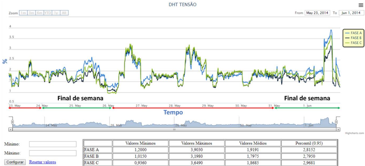
Figura 5-24 – Taxa de distorção harmônica total de tensão medida do transformador DITF4-04 da SE DI. Fonte: Elaborado pelo autor.
