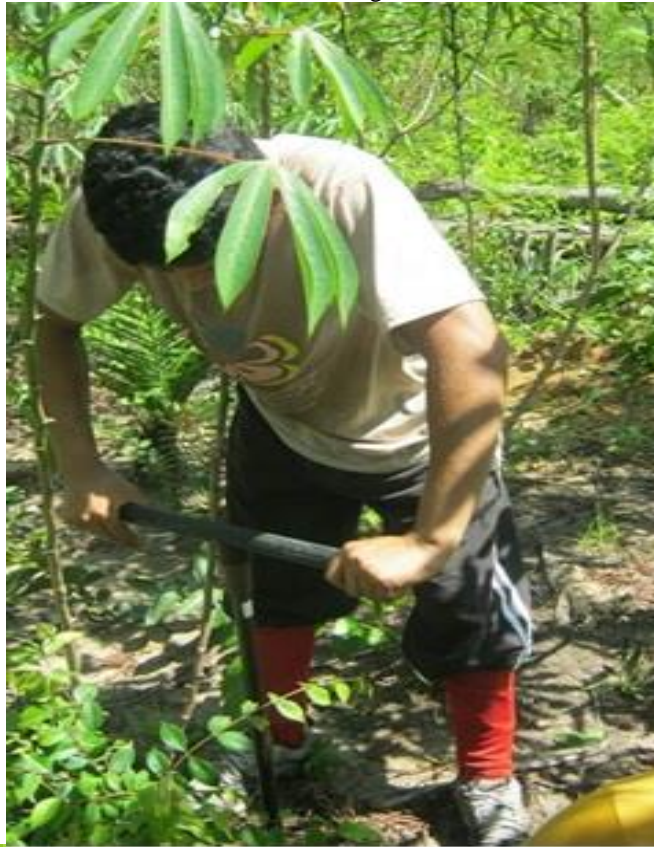
Figura 8 - Coleta de amostras de solo no centro da área agrícola, utilizando trado boca de lobo.
