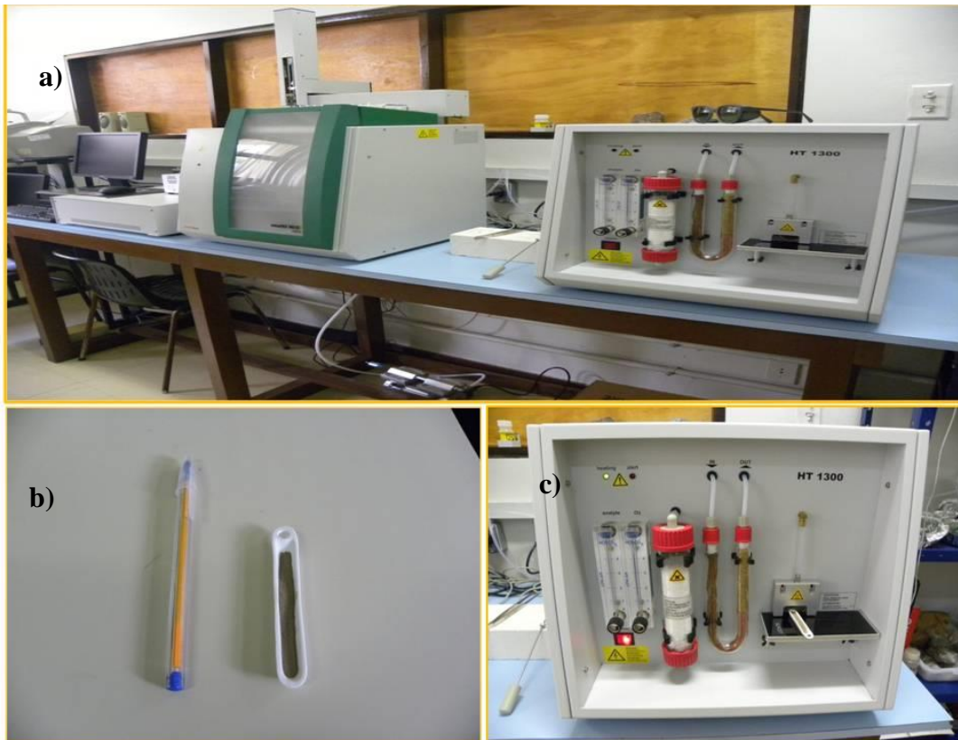
Figura 40 - Análise do Carbono Orgânico Total. a) Equipamento analisador de COT, da Analytik Jena modelo multi N/C 2100/2100 S; b) Barquinha de porcelana com amostra de solo; c) Forno HT 1300 para sólidos com alta temperatura para COT/CT.
