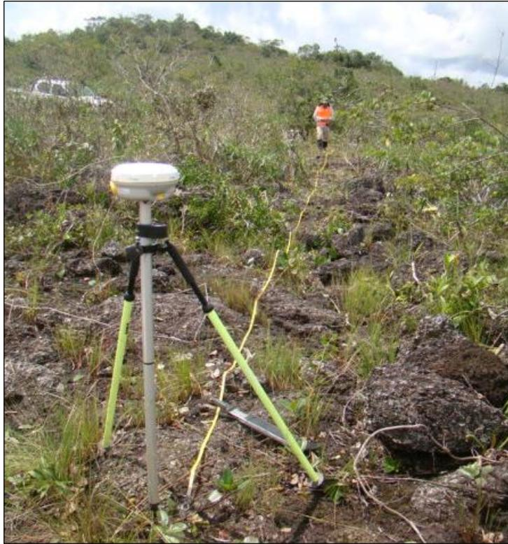
Figura 17- Obtenção da microtopografia em campo, com o uso de DGPS para leitura de coordenadas dos extremos do perfil.
