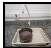
Figura 7. Materiais utilizados em campo e no laboratório para obtenção de biomassa de raízes: a) trado e marreta de madeira; b) sacos plásticos com amostras de solo identificadas; c) bancada de lavagem com bandeja, peneiras e torneira; d) estufa e) dessecador com amostras de raízes; f) balança analítica;
