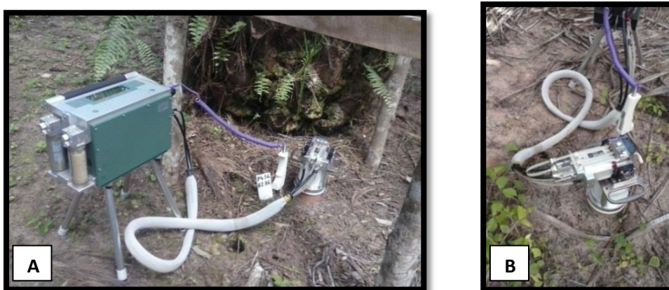
Figura 8. Equipamento utilizado para a medição do efluxo de CO 2 do solo composto de console e câmara de respiração do solo (a) e detalhe da câmara de respiração do solo e o termômetro (b).
