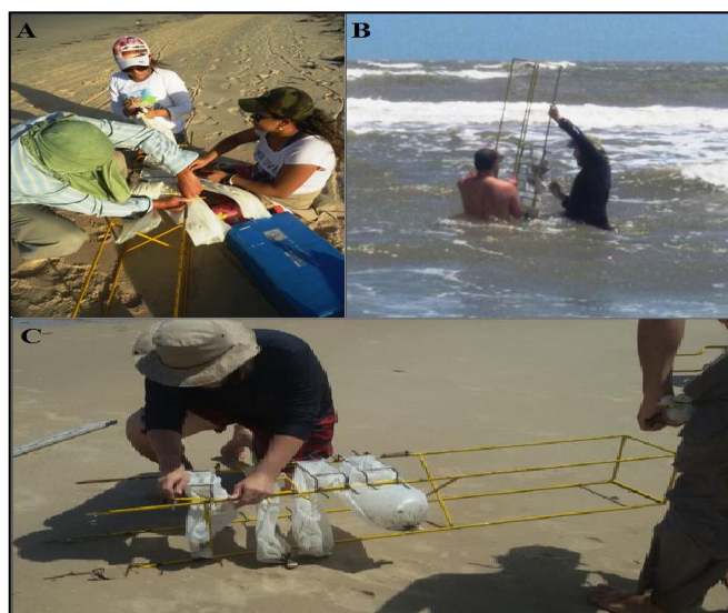
Figura 23- Armadilha de transporte de sedimentos longitudinal. Armação da armadilha (A), retirada das armadilhas da água (B) e (C) retirada das redes.
