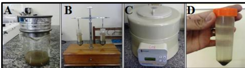
Figura 29- Etapas do peneiramento a úmido. A) Desagregação da amostra. B) Balanceamento da amostra para utilização da centrífuga. C) Centrífuga para separação de silte/argila. D) Amostra após o processamento.
