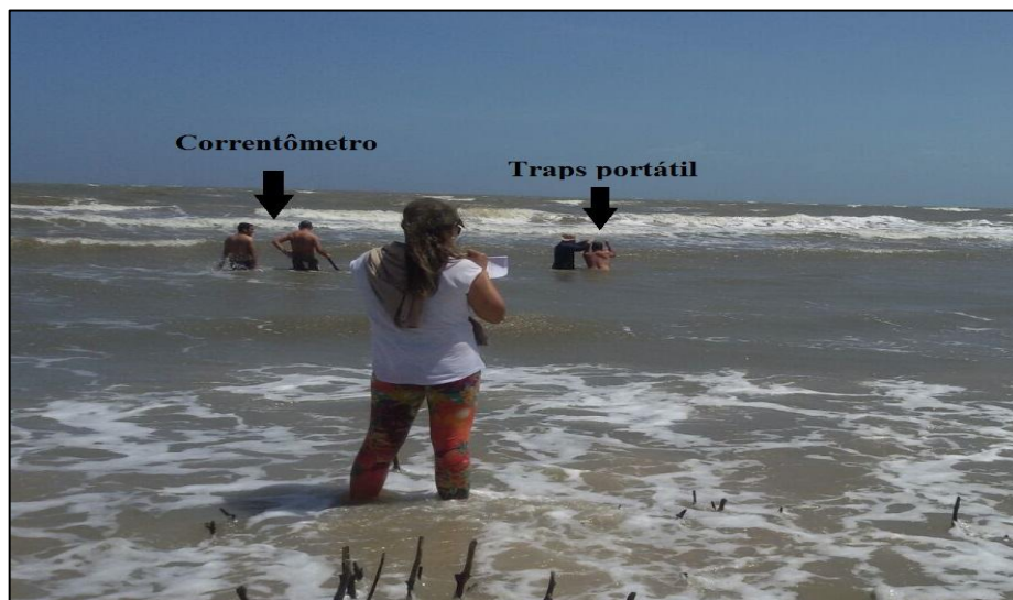
Figura 26- Correntômetro fundeado próximo á armadilha para verificar a intensidade da corrente que passa na armadilha.
