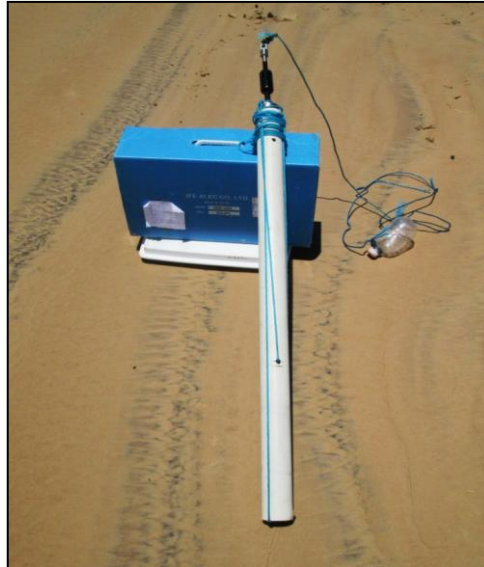
Figura 25- Correntômetro acoplado a um tubo PVC na praia do Cajuúna.
