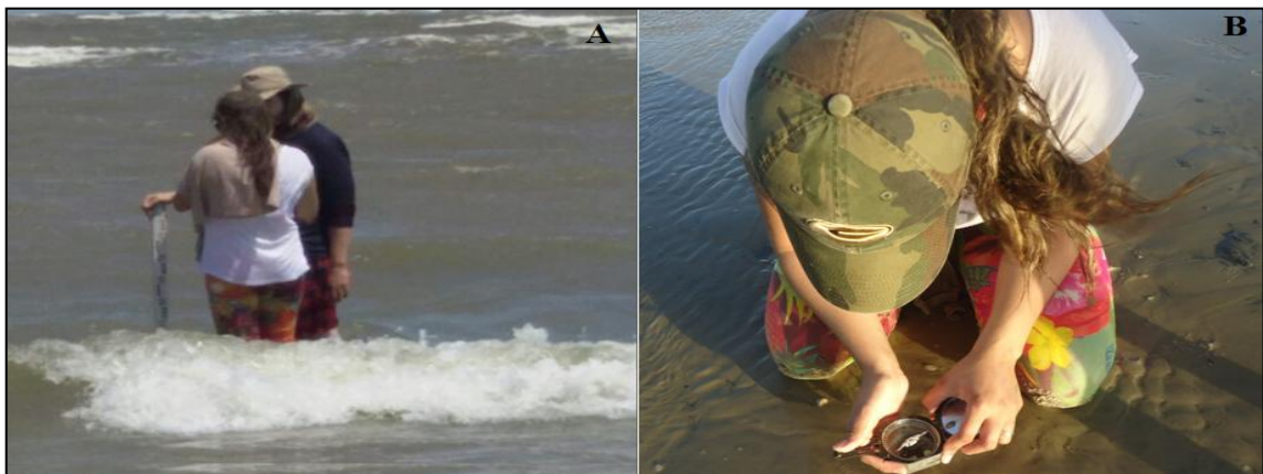
Figura 24- Medida da altura das ondas (A) e medidas feitas com a bússola para obter o ângulo de incidência das ondas (B).
