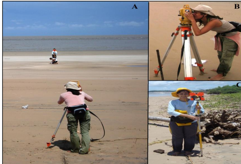
Figura 19- A) Medição topográfica do perfil transversal á linha de costa na praia do Cajuúna; B) estação total; C) Prisma refletor (foto em 04/2014).
