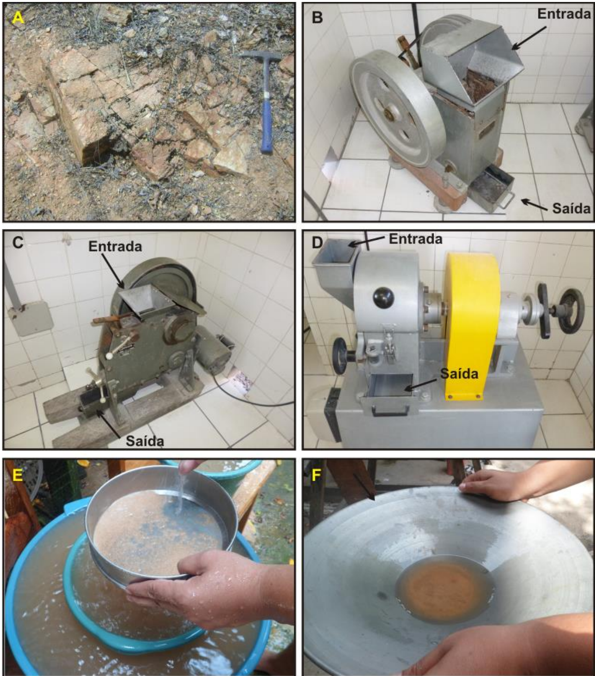
Figura 2.5 - A) Amostras de quartzito utilizada na análise U-Pb; B) Britador de mandíbulas fixo; C) Britador de mandíbulas regulável; D) Moinho de discos utilizado na fragmentação da rocha; E) Peneiramento das amostras para separação das frações granulométricas; F) Bateia utilizada na concentração dos minerais pesados.
