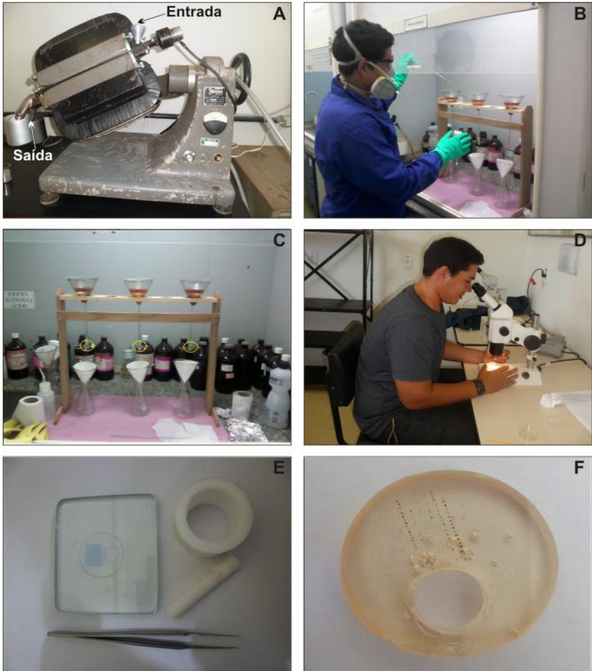
Figura 2.6 - A) Equipamento Frantz utilizado na separação dos minerais magnéticos; B) Imersão das amostras em Bromofórmio; C) Concentração dos minerais pesados no fundo do funil; D) Separação dos zircões com auxílio da lupa binocular; E) Material utilizado na confecção da pastilha; F) Pastilha com cristais de zircão colados na superfície.
