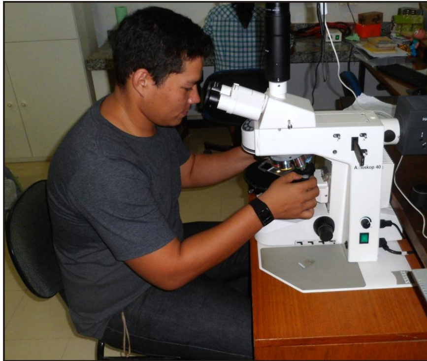
Figura 2.2 - Microscópio petrográfico de luz polarizada utilizado nas descrições das seções delgadas das amostras de rochas.
