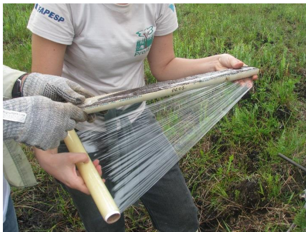
Figura 3. Testemunho armazenado em tubos e filme PVC para evitar contaminações.
