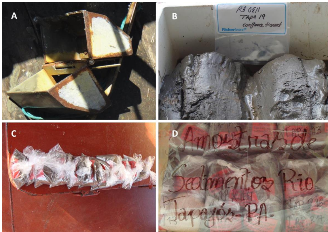
Figura 4.3- Ferramenta de coleta – draga de Petersen (A), basquetas plásticas para coleta de amostras (B) e posterior armazenamento em sacos plásticos identificados (C e D)
