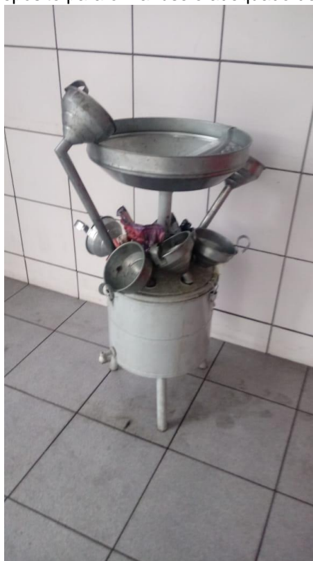
Figura 14: Funil com depósito para o manuseio adequado de óleos lubrificantes
