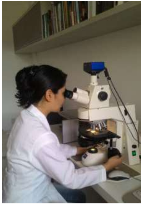
Figura 3: Leitura de lâmina em Microscópio Carl Zeiss Axioskop 2 plus com câmera acoplada.
