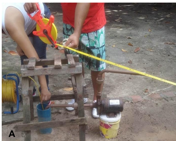
Figura 1- (A) Medição do nível estático e verificação da distância do poço para fossa da residência.
