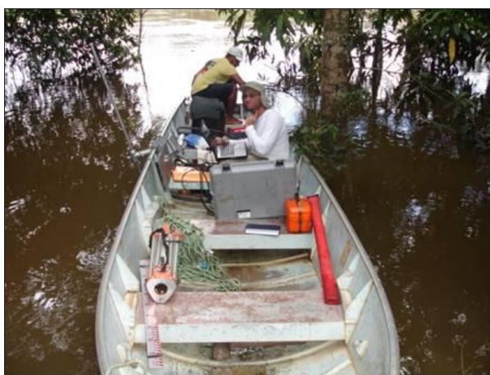
Figura 16: Medição de vazão com ADCP (Acoustic Doppler Current Profile) na estação Fazenda Fonte:Acervo CPRM/PA
