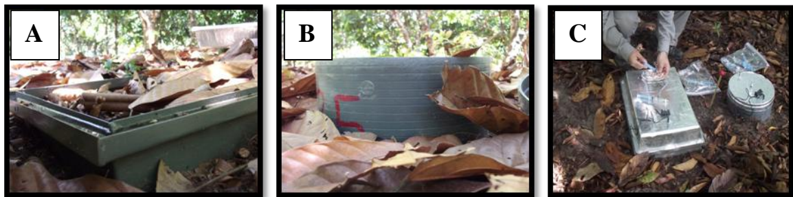
Figura 4: Detalhes das bases das câmaras retangular (A) e cilíndrica (B) inseridas no solo. Coleta de gases com seringas (C).
