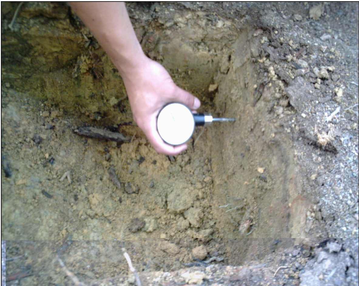
Figura 12 - Trincheira aberta para medidas de resistência do solo à penetração nas profundidades de 0-5, 5-10, 10-20 e 20-30 cm.
