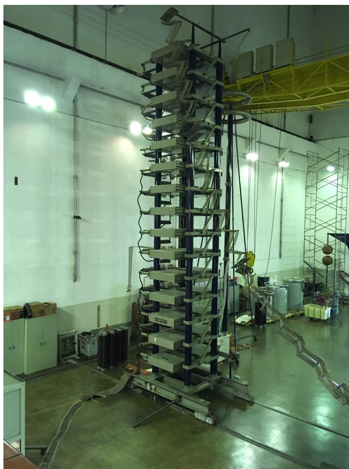
Figura 17 – Gerador de impulsos de tensão 3000kV do IEE-USP.
