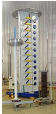
Figura 15 – Gerador de impulsos de corrente do LEAT-UFPA.
