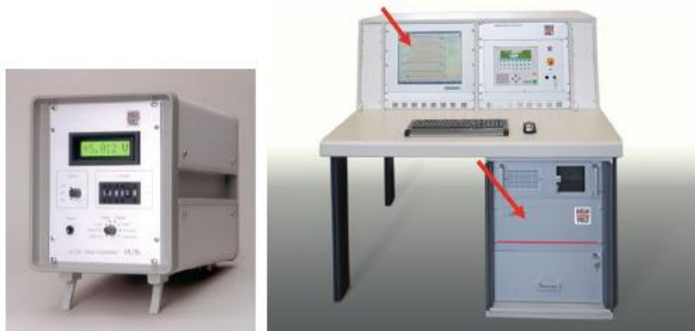
Figura 12 – Sistema de aquisição de dados (SAD) para medição em alta tensão
