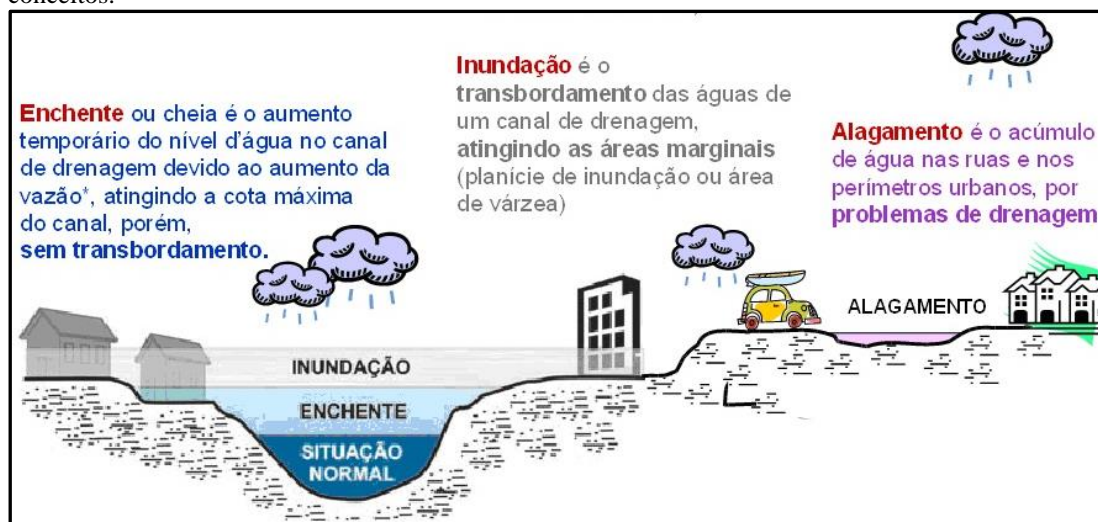
Figura 2 - Perfil esquemático dos processos de enchente, inundação e alagamento, com seus respectivos conceitos.
