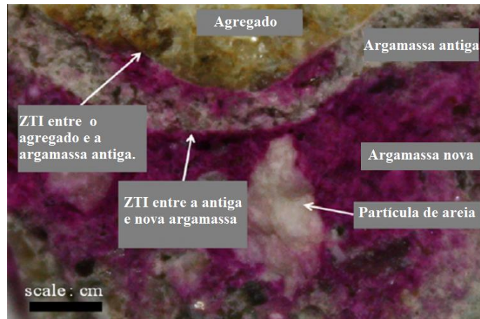
Figura 2.1- Seção de uma matriz de concreto com agregado reciclado (Adaptado de G.C. LEE e H.B. CHOI).
