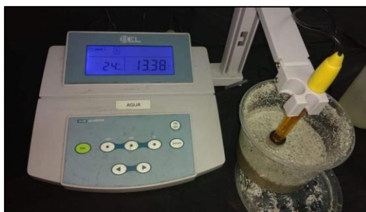
Figura 43 – Ensaio de pH da solução após 30 dias de ensaio
