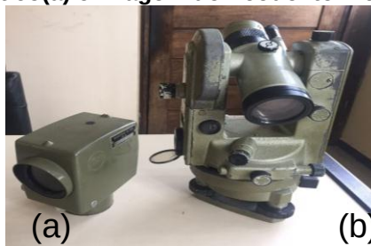
Figura 3: Nível ótico(a) e Imagem do Teodolito mecânico(b).
