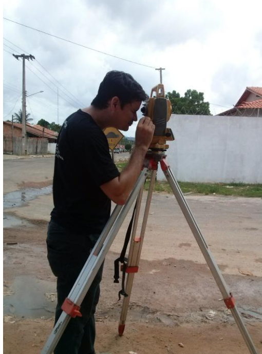
Figura 10: Levantamento topográfico com estação total.
