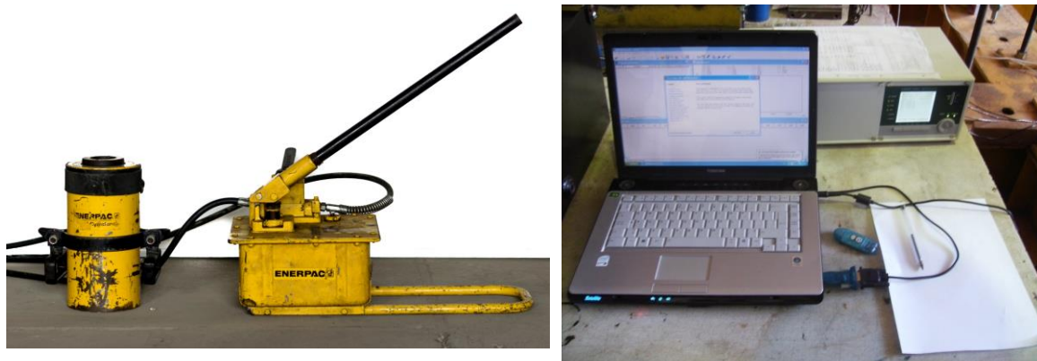
Figura 4.27 – Atuador hidráulico, Notebook e ALMEMO 5690-2M
