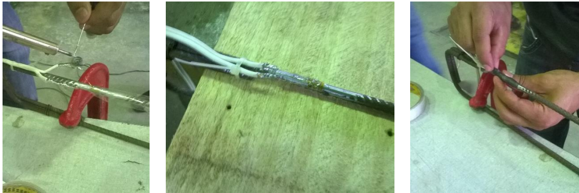
Figura 4.20 – Instrumentação das barras
