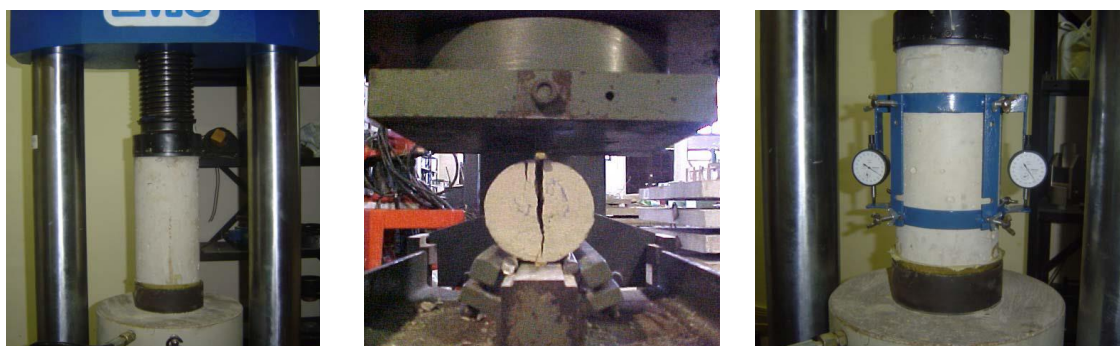
a) Compressão axial b) Compressão diametral c) Módulo de elasticidade
