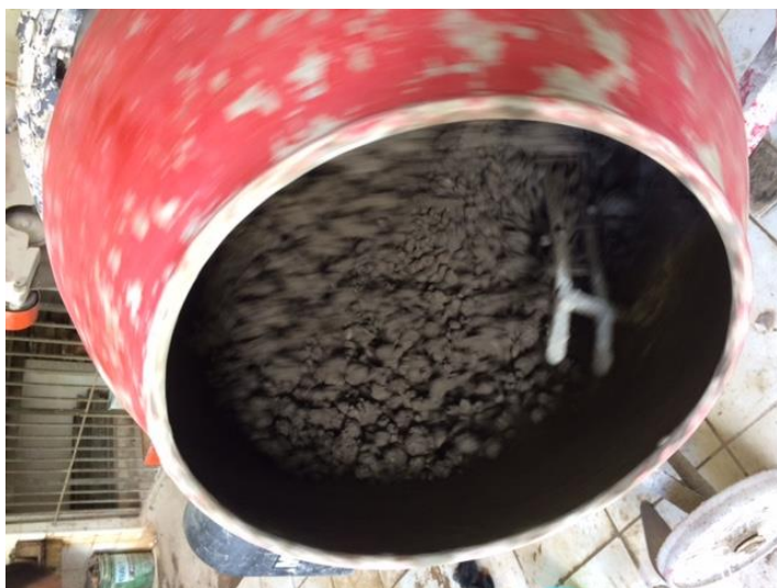
Figura 26 – a) Mistura com rejeito de manganês b) Slump-test para mistura com rejeito de manganês.
