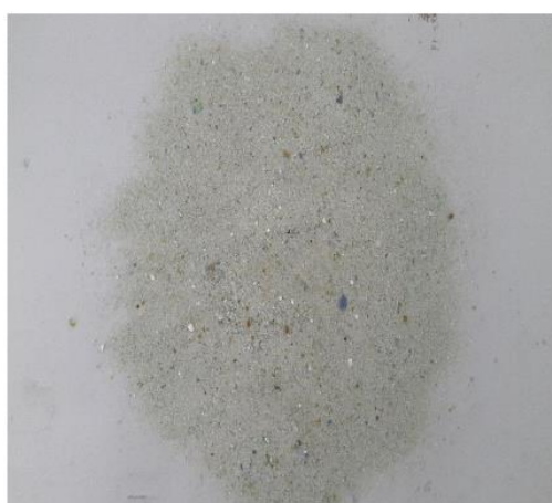
Figura 11 – a) Resíduo de vidro e b) Forma das partículas do resíduo de vidro
