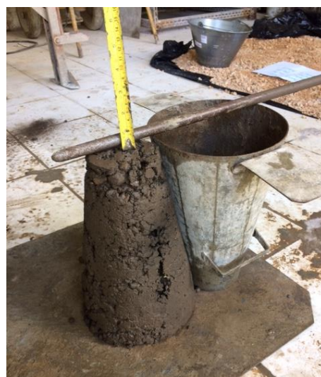
Figura 26 – a) Mistura com rejeito de manganês b) Slump-test para mistura com rejeito de manganês.
