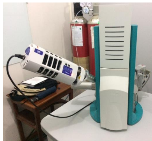
Figura 17 – a) Amostra do rejeito de manganês b) Equipamento que realiza o ensaio de MEV e de EDS
