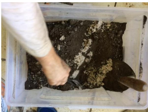
Figura 19 – Homogeneização da areia com rejeito de manganês
