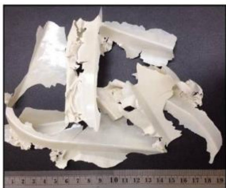
Figura 10 – a) Reciclado de malamina formaldeído b) Malamina formaldeído triturado Fonte: Chalermchai Chaitongrat e Somsak Siwadamrongpong (2018)
