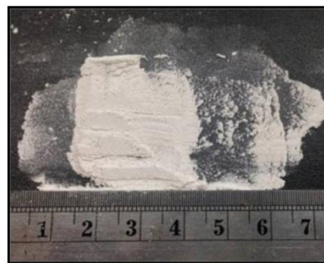
Figura 10 – a) Reciclado de malamina formaldeído b) Malamina formaldeído triturado Fonte: Chalermchai Chaitongrat e Somsak Siwadamrongpong (2018)
