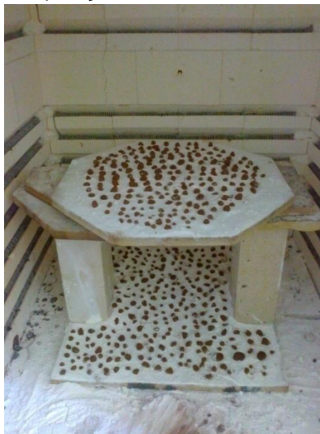
Figura 3.5 – Disposição do material dentro do forno
