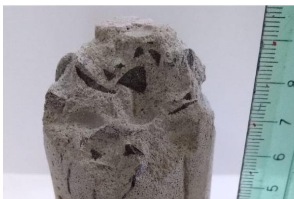
Figura 4.10 – Ampliação da ruptura do concreto
