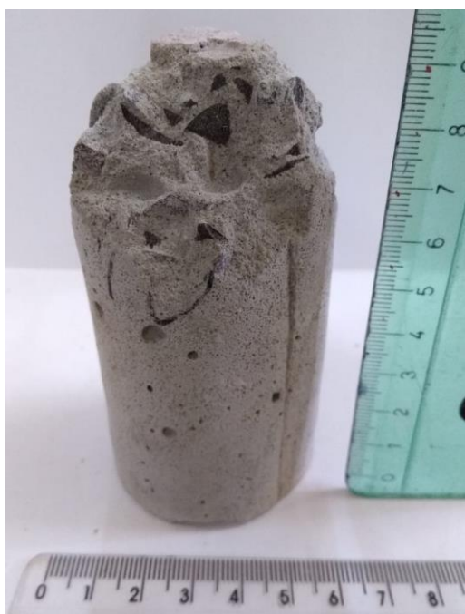
Figura 4.9 – Ruptura do concreto
