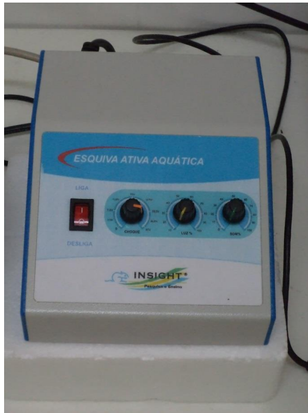
Figura 3. Gerador de choques elétricos. O 1º botão era o de controle de voltagem; o 2º de intensidade luminosa e o 3º era o de intensidade sonora. Na parte de trás estava localizada a chave para mudança de corrente elétrica.
