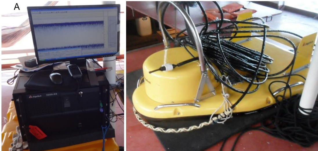
Figura 16: Sistema de perfilagem Sub-Botton 3200-XS. A esquerda, unidade de plataforma e a direita o perfilador (SB-512i).
