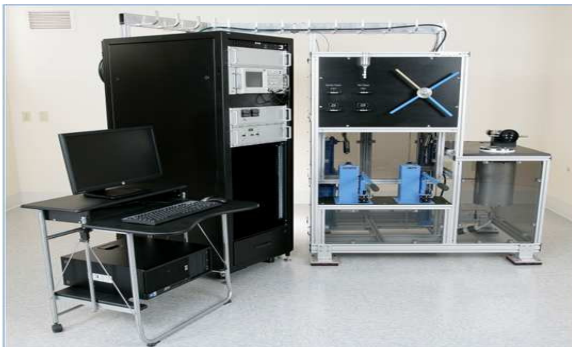
Figura A.9 – Sistema Autolab500 usado para medir as propriedades elásticas da rocha. Este aparato pertence ao Laboratório de Petrofísica da UFCG.
