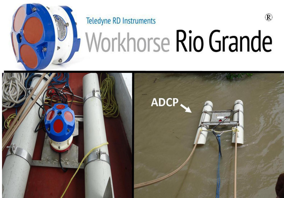
Figura 6 - Preparação e utilização do ADCP para coleta de dados
