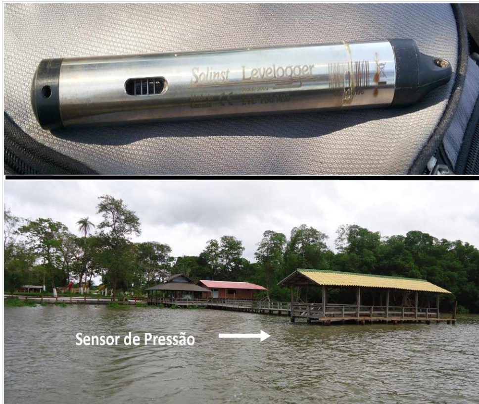
Figura 7 - Sensor da marca Solinst Levelogger 3001 e o píer onde esteve instalado durante as coletas
