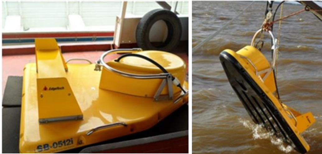
Figura 24: Veículo hidrodinâmico (Towfish) Sub-Bottom profiler SB-0512 produzido pela Edge Tech antes do funcionamento.
