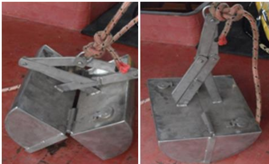
Figura 23: Amostrador de fundo do tipo Van Veen travado e destravado, com capacidade de 20 litros. Utilizado para coleta de amostras de sedimentos do assoalho marinho.
