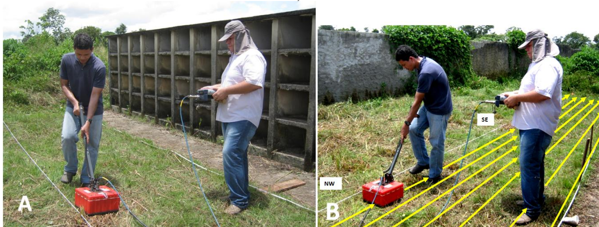
Figura 4.11 (A) Aquisição de dados GPR com antena biestática blindada de 400 MHz e (B) Espaçamento entre linhas de 0,25 m.
