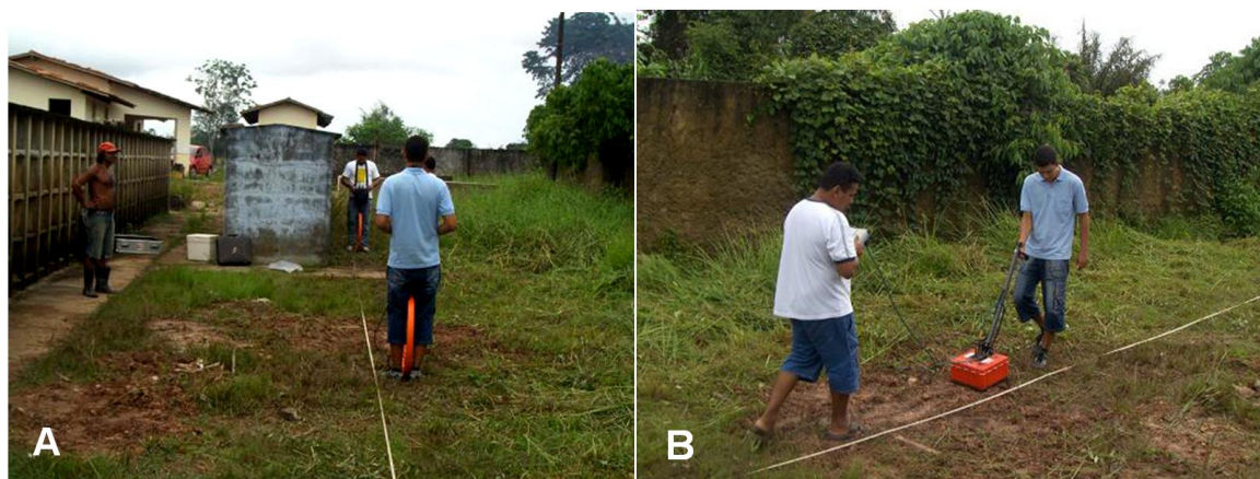
Figura 4.6 (A) Levantamento com o LIN EM34-3 e (B) Levantamento com o GPR
