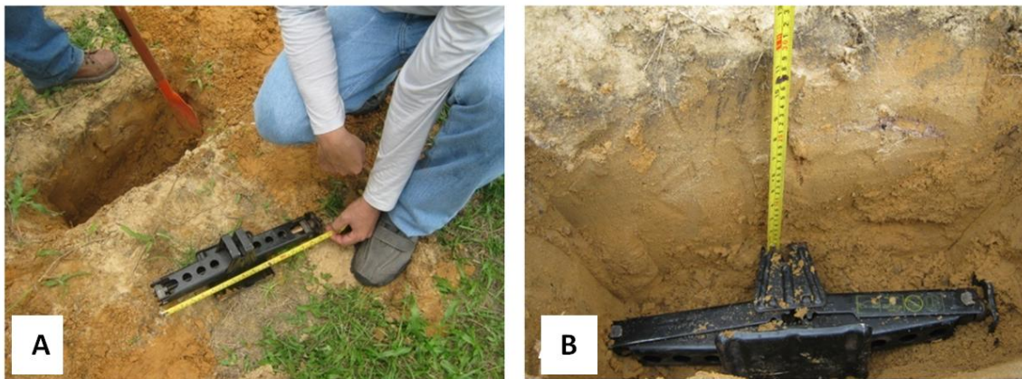
Figura 6.3 (A) Objeto metálico de 30 cm de comprimento (“macaco” de carro). (B) Medida da profundidade (30 cm) de seu enterramento para o teste de velocidade em Mosqueiro.
