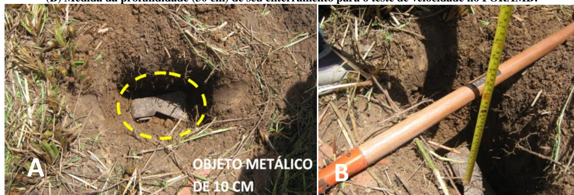
Figura 4.9 (A) Objeto metálico de 10 cm de comprimento (“cabeça” de machado). (B) Medida da profundidade (30 cm) de seu enterramento para o teste de velocidade no FORAMB.
