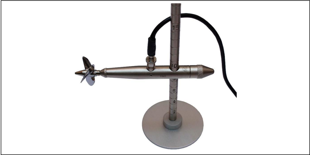
Figura 12 - Molinete para medição de velocidade da água.
