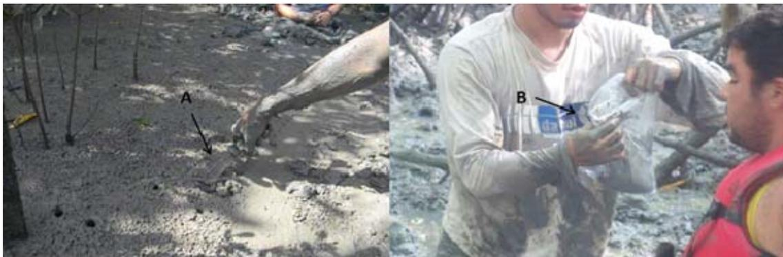
Figura 14 - Imagem mostrando o esquema da coleta de sedimento superficial no manguezal. **A** espátula de coletar sedimento e **B** embalagem plástica de armazenamento do sedimento.
