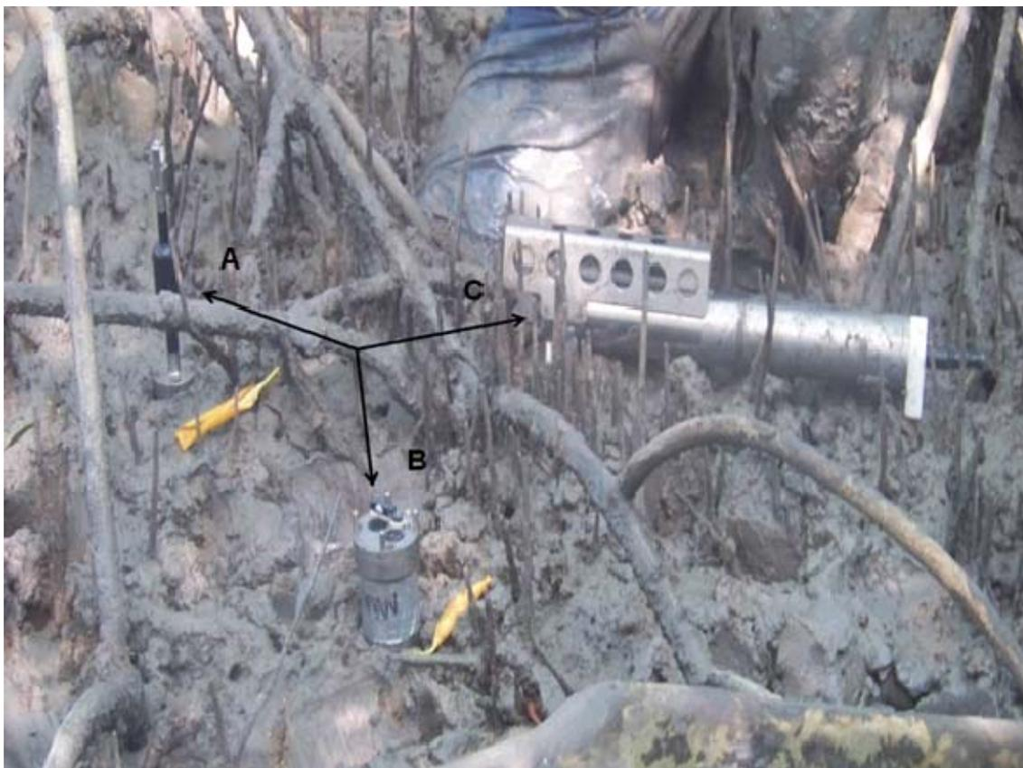
Figura 11 - Imagem mostrando os sensores e a disposição dos equipamentos da segunda estação fixa localizada no manguezal vegetado. **A** está indicando o sensor do EMCM, **B** sensores do OBS e **C** sensores do CTD sobre o sedimento lamoso.
