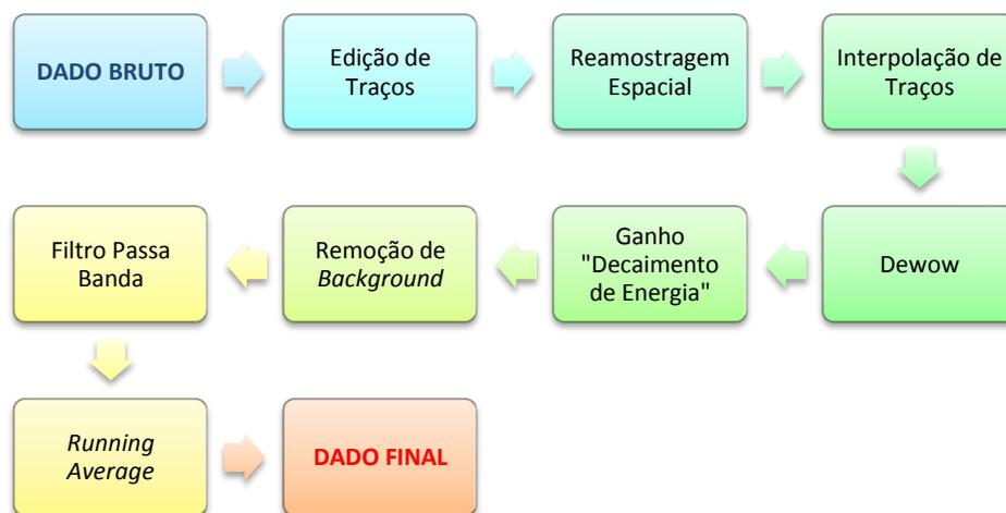
**Figura 15 – Sequência de processamento utilizada nos dados de Belém e Santarém.**
