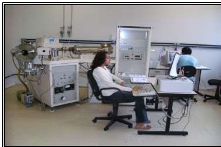
Figura 12- Espectrômetro de massa Finnigan MAT 262 – TIMS, Laboratório de Geologia Isotópica – Instituto de Geociências (UFPA)
