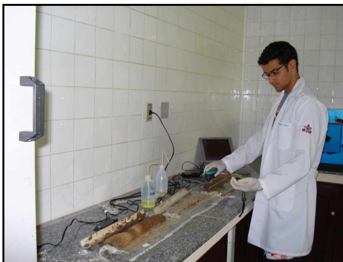
Figura 04 - Obtenção de valores de reflectância espectrofotométrica através da utilização de um espectrofotômetro portátil após o uso de reagentes em testemunho sedimentar.
