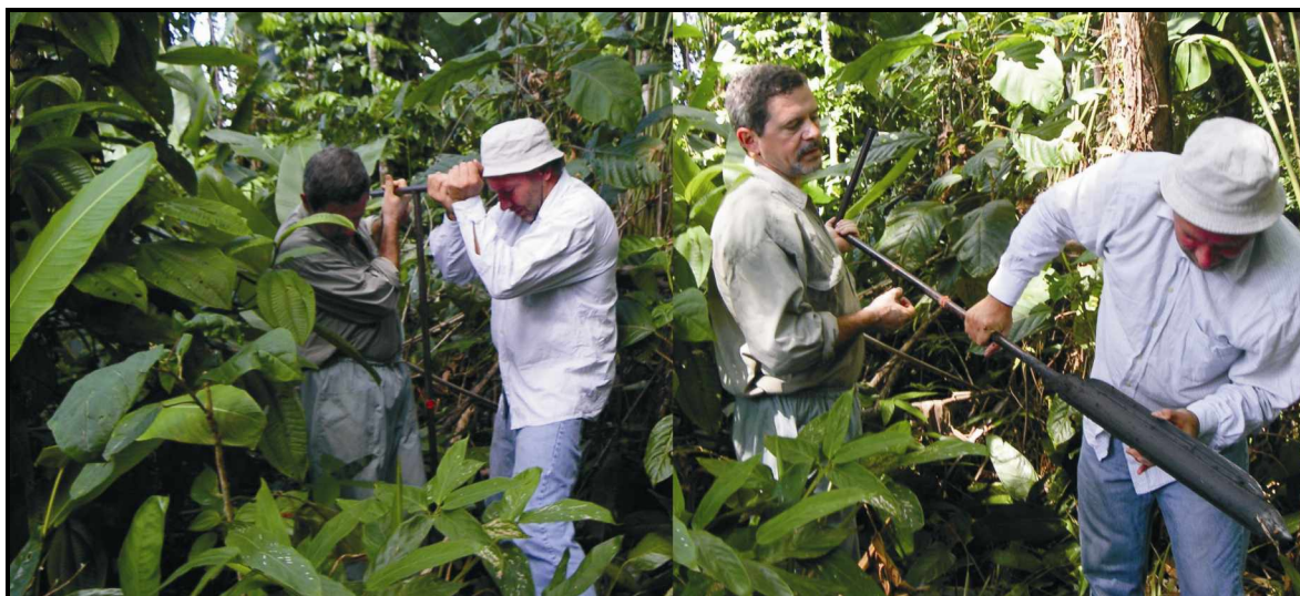
Figura 01 - Coleta de testemunhos sedimentares utilizando o amostrador russo .
