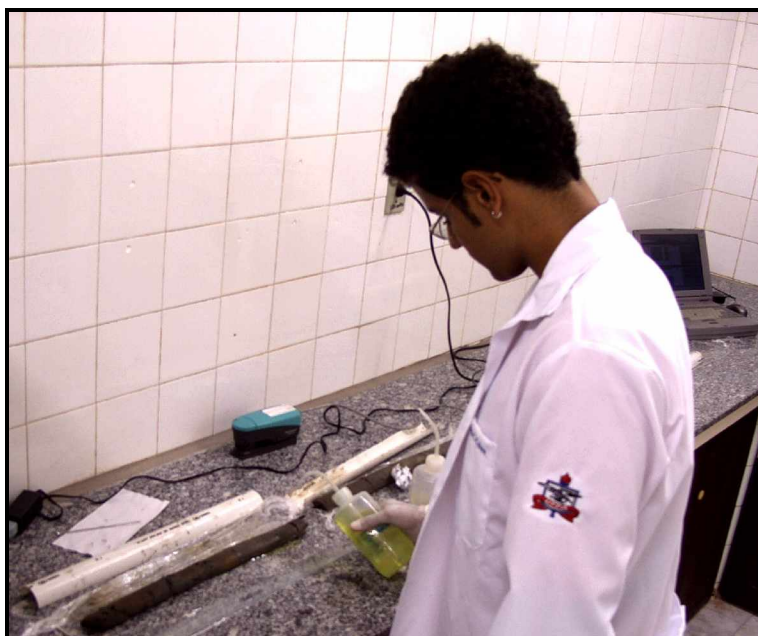
Figura 02 - Utilização dos reagentes cloreto férrico ( \text{FeCl}_3 ) e hexacianoferrato de potássio ( \text{K}_3\text{Fe}(\text{CN})_6 ) em testemunho sedimentar.
