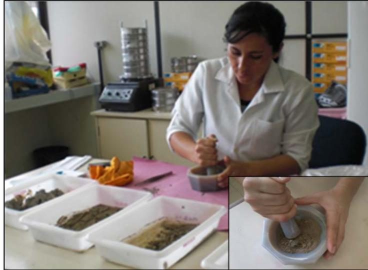
Figura 11: Fotografia -Processo de desagregação das amostras de sedimento de fundo
