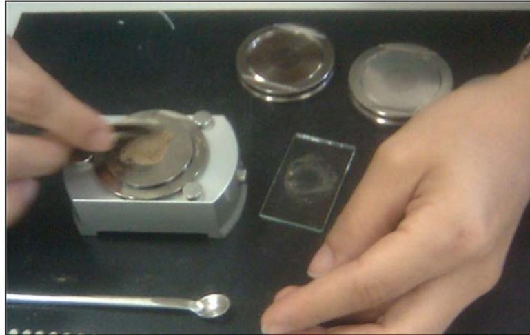
Figura 14: Fotografia -Preparação da amostra total de sedimentos de fundos pelo método do pó
