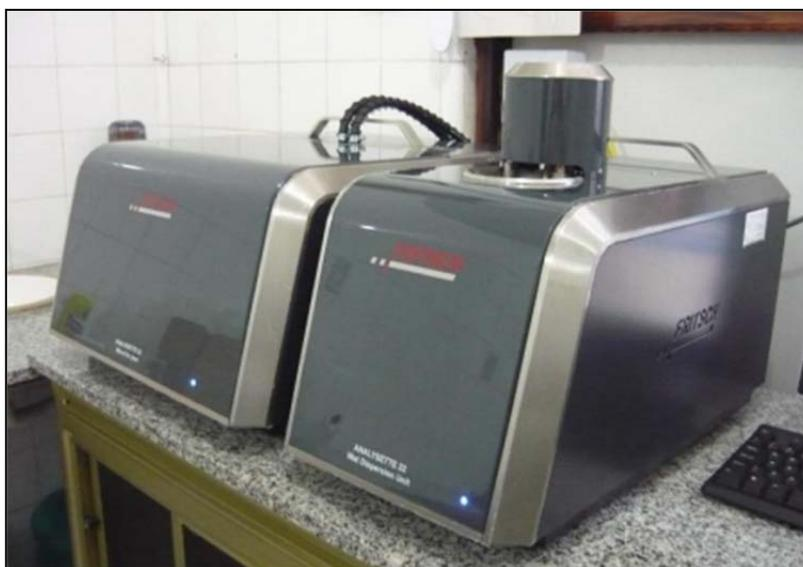
Figura13: Fotografia -Analisador de partículas a laser - ANALYSETTE MICROTEC PLUS
