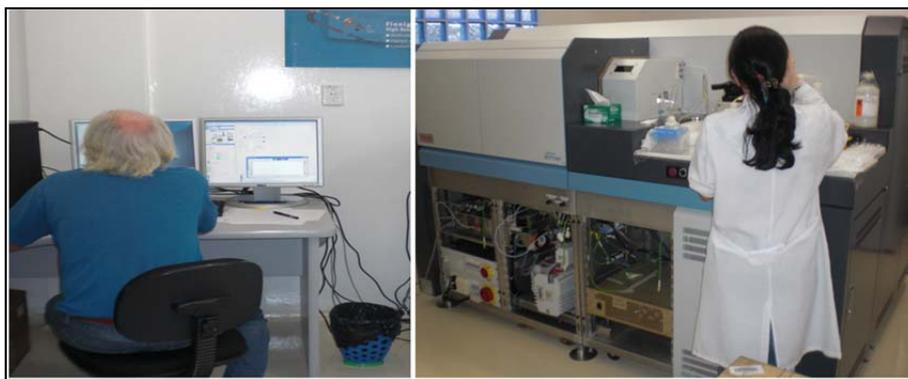
Figura 17: Fotografia - Espectrômetro de Massa com fonte de plasma – Neptune - MC-ICPMS
