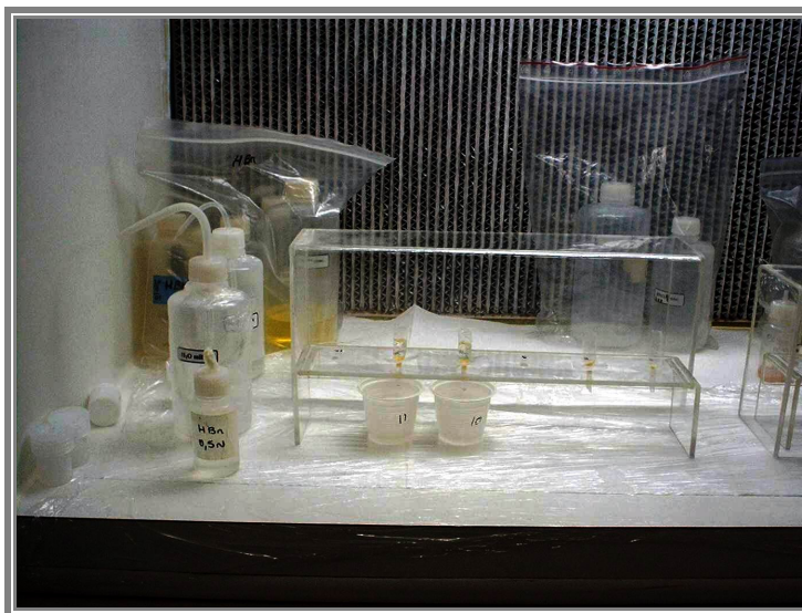
Figura 13 – Microcolunas de separação química de Pb das amostras por cromatografia em resina de troca iônica.
