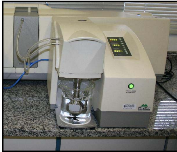
Figura 4.6: Unidade de dispersão a úmido Hydro2000 .
