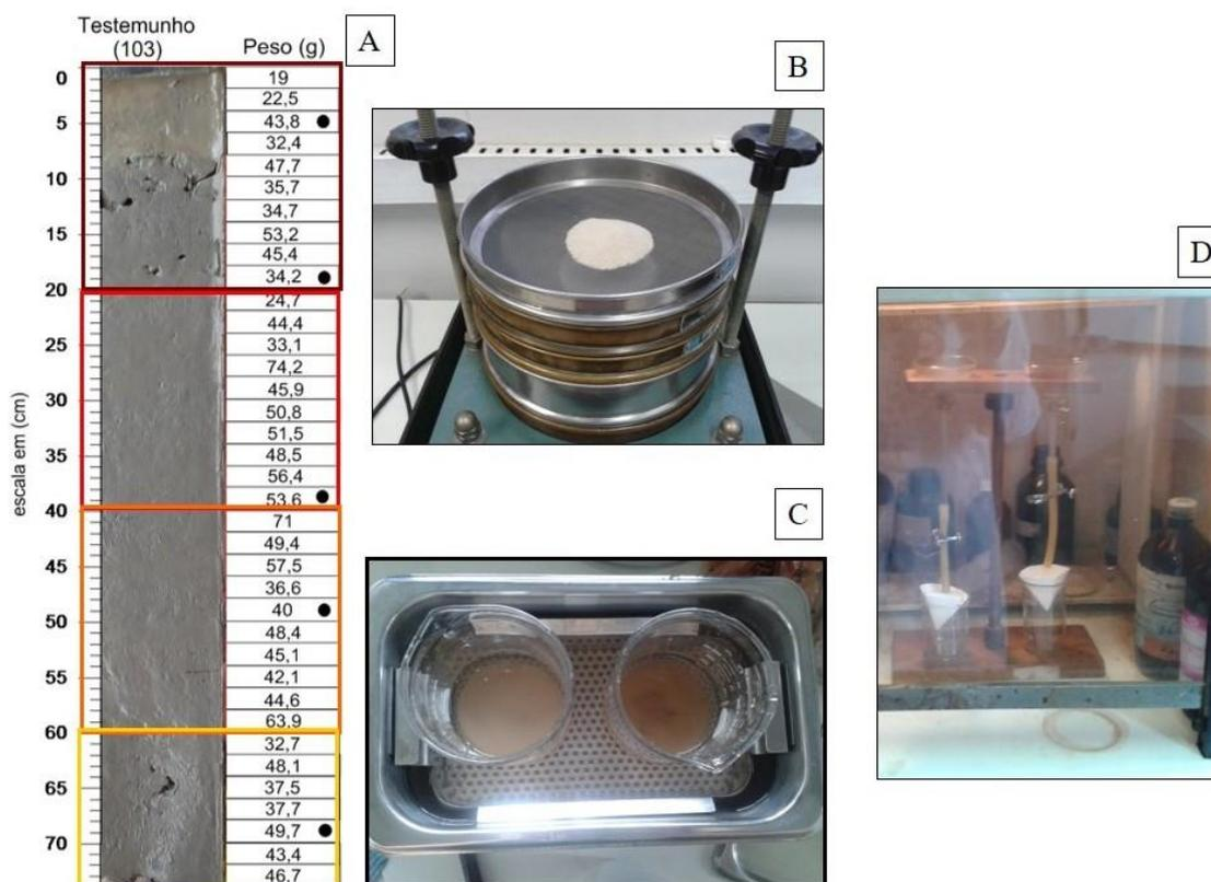
Figura 6 - Exemplos dos procedimentos realizados: A) demonstração dos pacotes de junção de um dos perfis para extração de minerais pesados; B) peneiramento para extração das frações de 0,125 e 0,063 mm; C) limpeza dos grãos com HCl em ultrassom por 10 min.; D) extração de minerais pesados por densidade com uso de bromofórmio.
