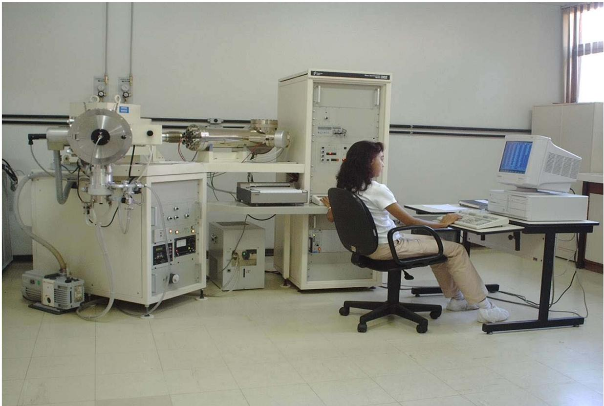
**Figura 14-** Aspecto do Espectrômetro de Massa Finnigan MAT 262 do Pará-Iso.
