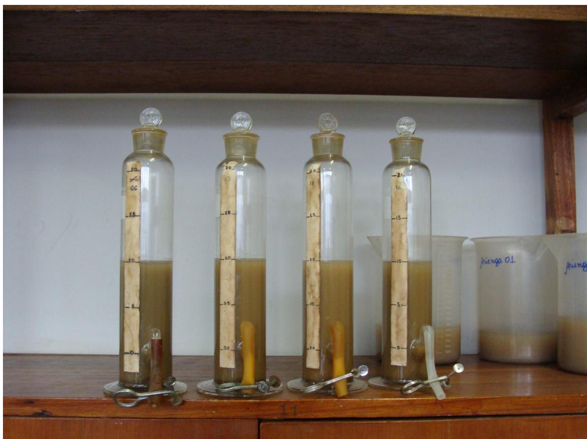
Figura 12 - Separação das frações silte-argila utilizando o cilindro de Atterberg.
