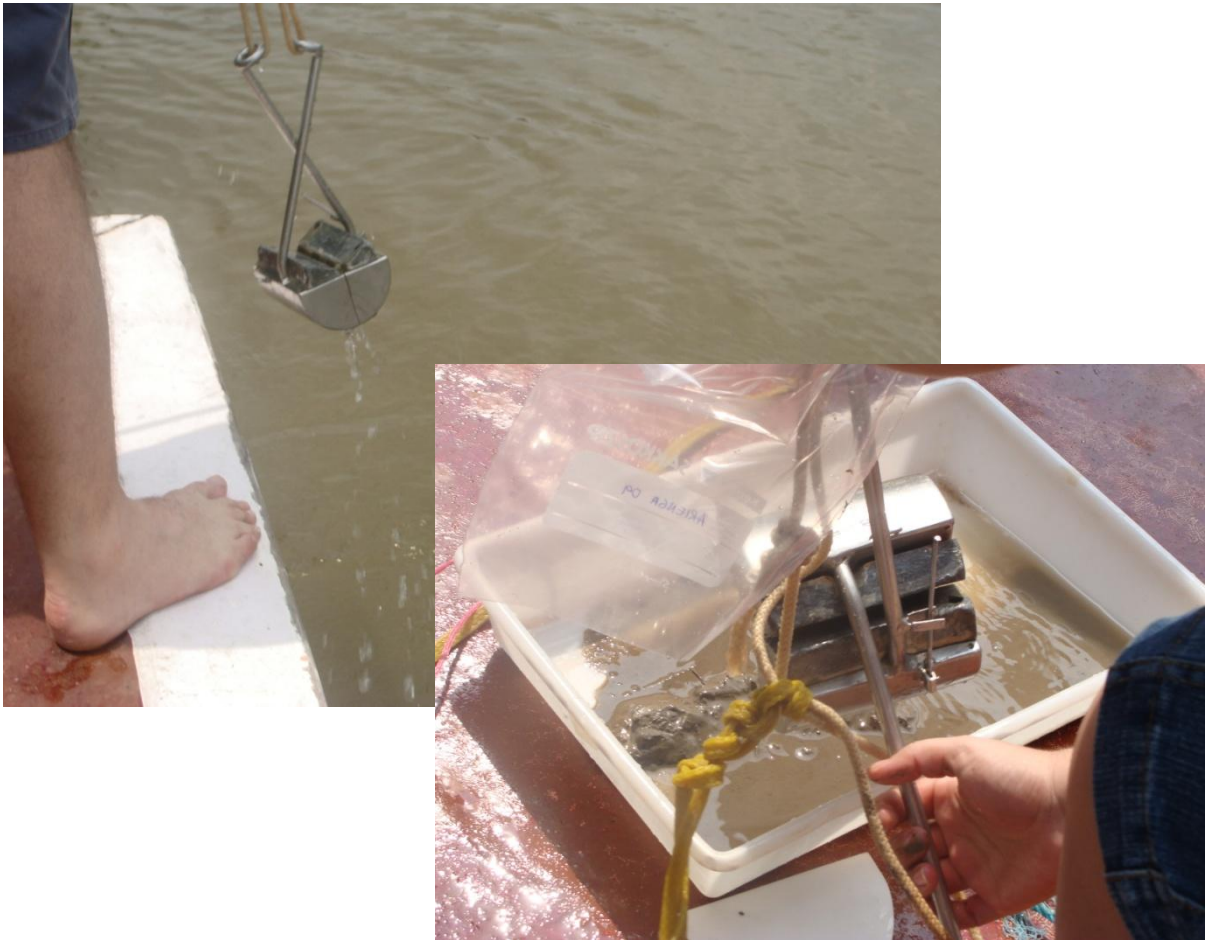
Figura 9 - Coleta de amostra com draga de Petersen ao longo do rio Arienga.
