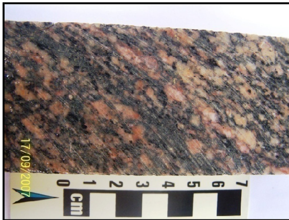
Figura 5.1- Fotografia de testemunho de furo de sondagem de metagranodiorito porfirítico levemente foliados da Suíte Intrusiva Tropas, (Amostra 03/24 179,75m).
