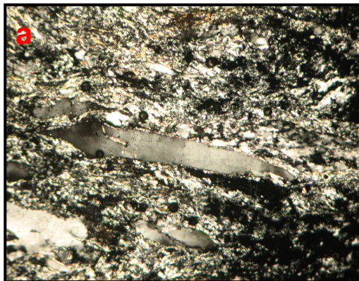
Figura 5.16- Fotomicrografia de quartzo em milonito, mostrando porfiroclasto estirado em uma matriz de quartzo recristalizado em (a) (Amostra 26/54-129,28m, LT, Nicóis X 10x) e augens de quartzo em (b) (27/61-189,33m, LT, Nicóis X 20x).
