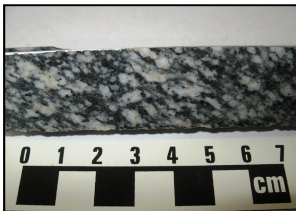
Figura 4.2- Fotografia de testemunho de furo de sondagem de granodiorito da Suíte Intrusiva Tropas, com orientação protomilonítica nas porções afetadas pelo cisalhamento. (FURO-27/62 198,20m).
