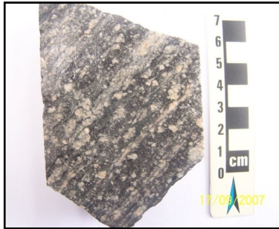
Figura 5.12- Fotografia de testemunho de furo de sondagem em milonito mostrando o aumento da proporção matricial da rocha e diminuição do tamanho e quantidade dos porfiroclastos de plagioclásio (Amostra Furo ORM 36/1-83,70 m).
