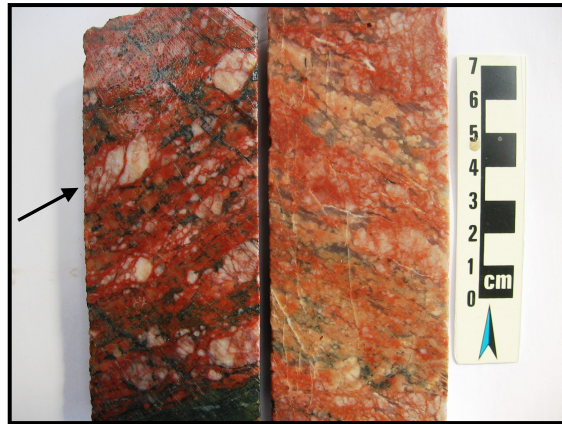
Figura 5.10- Fotografia de testemunho de furo de sondagem do protomilonito mostrando feições macroscópicas de deslocamento e rotação de fragmentos por fraturas de cisalhamento (seta). (Amostra 30/41-110,89m).
