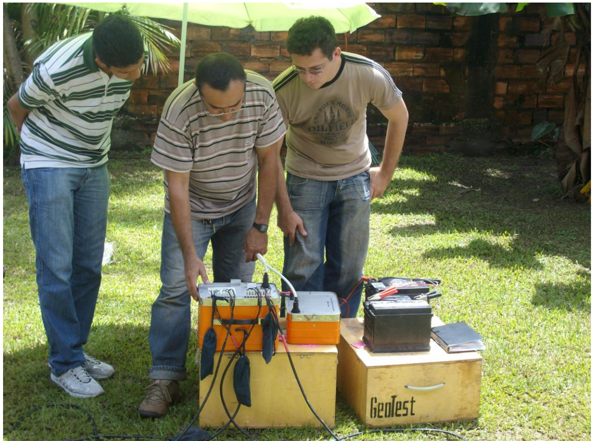
Figura 5.2 – Levantamento IP/Eletrorresistividade realizado em residência (Perfil 6).
