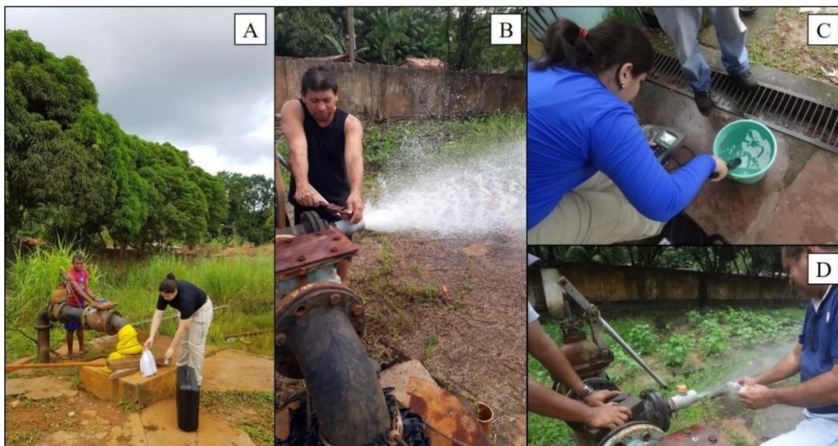
Figura 4- Procedimentos de amostragem. (A), (B) e (D) corresponde ao ponto PSF-01, com amostragem feita diretamente do poço. (C) medição dos parâmetros físico-químicos com a sonda multiparâmetros HANNA 9829. Fonte: Da autora.
