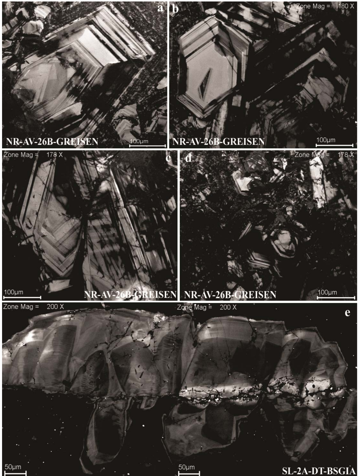
Figura 3.13: Imagens de MEV-CL de cristais de Qz5 identificados no muscovita-quartzo greisen (a-d) ou preenchendo cavidades nas rochas mais evoluídas (BSGIA) do GAV (e). Notar agregado de finos cristais de quartzo hidrotermal (Qz5) dispersos na rocha (d).
