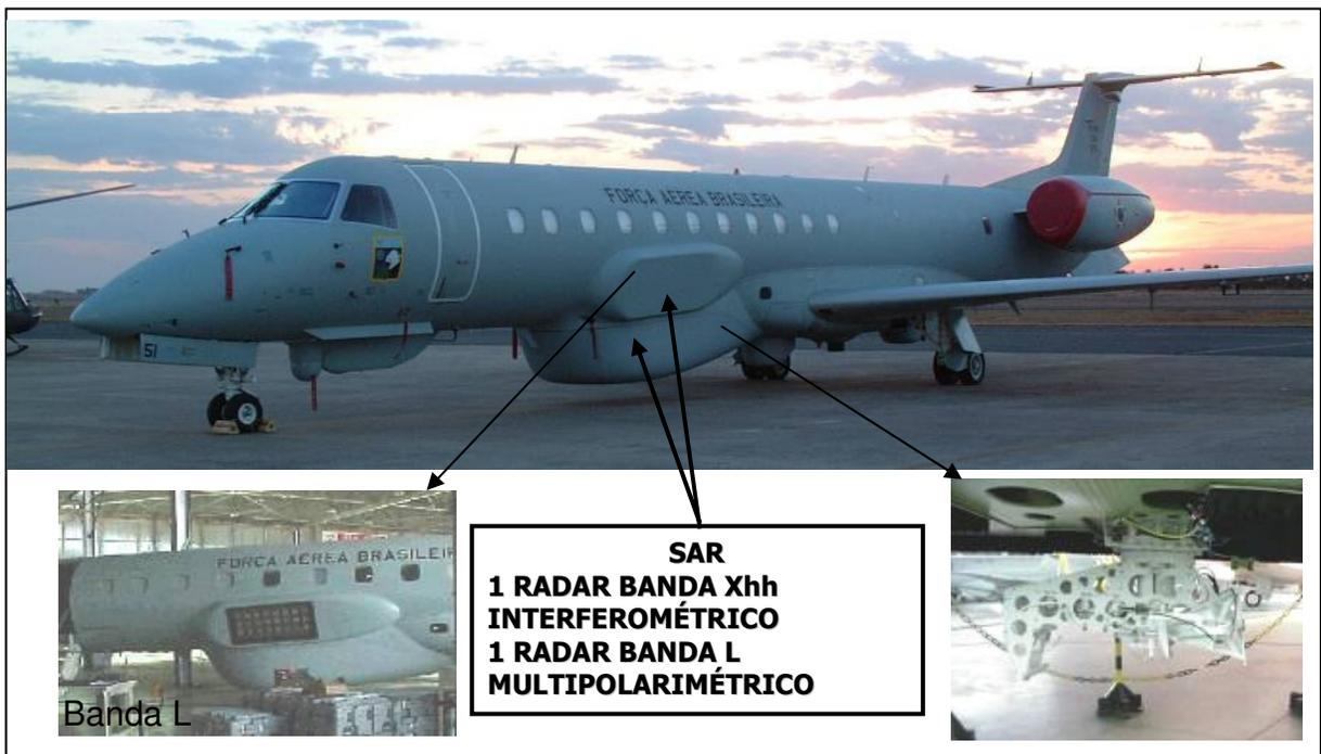
**Figura 4.1** – Aeronave de sensoriamento remoto, em destaque o SAR (SIPAM, 2006).
